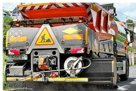
*\* Lors d'une réparation de chaussée au « point-à-temps », l'ouvrier répand une émulsion de bitume et de gravillons. Cette technique permet un entretien de la surface de la chaussée en redonnant de l'étanchéité.*
