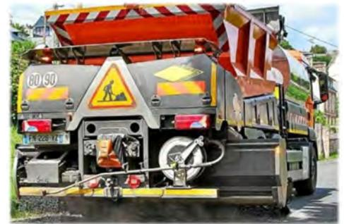
*\* Lors d'une réparation de chaussée au « point-à-temps », l'ouvrier répand une émulsion de bitume et de gravillons. Cette technique permet un entretien de la surface de la chaussée en redonnant de l'étanchéité.*
